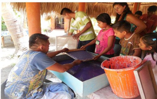
Tillverkning av böcker i returpapper Pappersmassan silas för att sedan torka och tillskärnas och bindas ihop till en bok.
